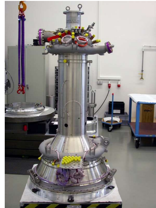
Chambre moteur Vinci
